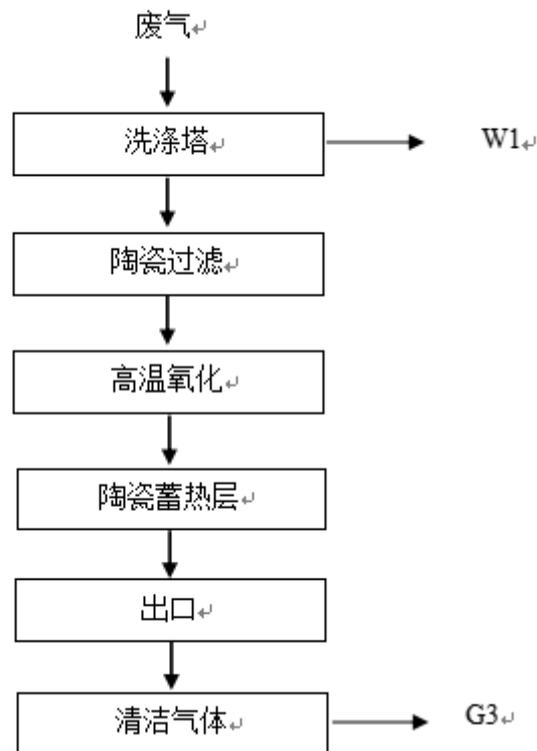
图 4.1-2 切换阀式 RTO 炉废气处理工艺
