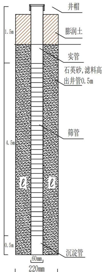
图 7.2-4 地下水采样井结构示意图
