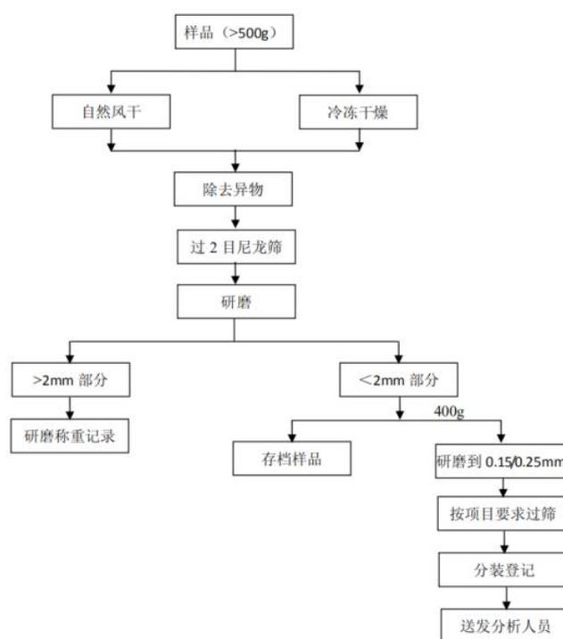
图 7.3-2 土壤样品制样流程图
