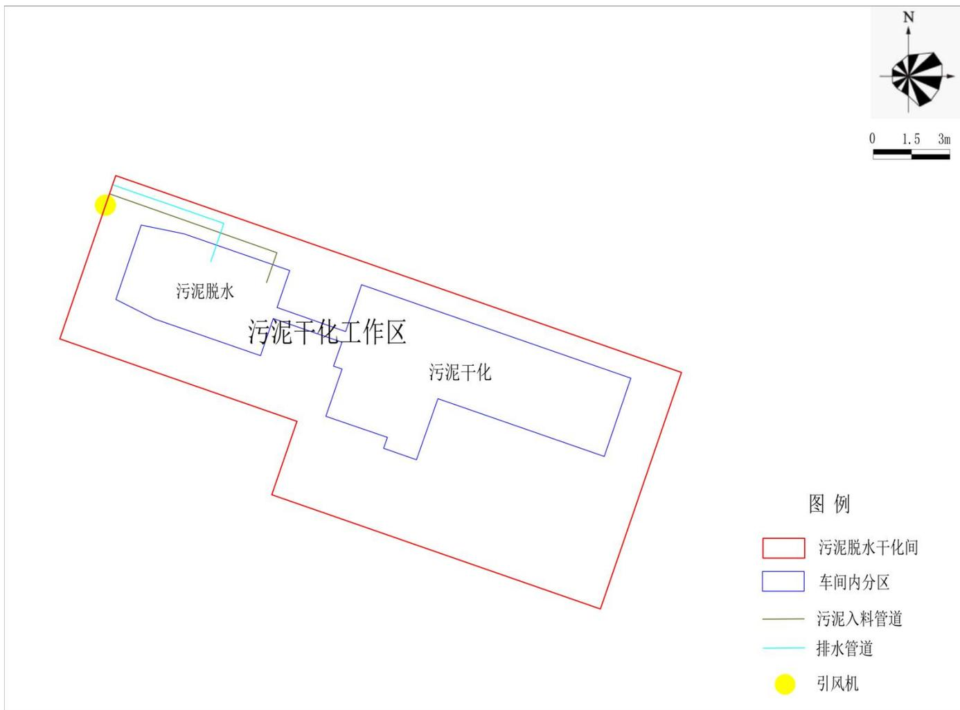
附图 3-1 项目平面布置图（污泥脱水干化间）
